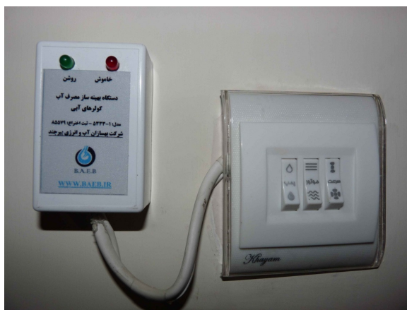
شکل ۴- نمایی از قطعه ساخته شده برای کاهش مصرف آب کولرهای آبی تولیدی ایران توسط شرکت دانش بنیان بهسازان آب و انرژی بیرجند
